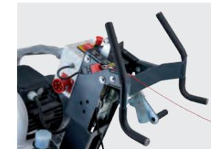
Führungsbügel mit Anti-Vibrationsschutz = verbesserte Ergonomie
