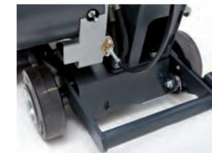
Fußhebel für Transportstellung = Schnelles Umsetzen der Maschine
