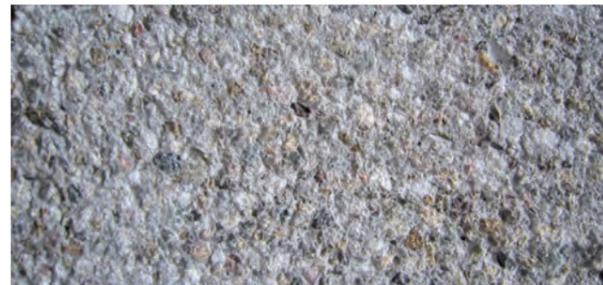
Fräsen von Betonböden mit dem System Schwamborn
